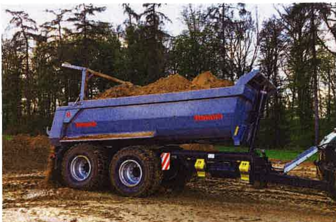
Für Reisch haben Wannenkipper mit hydraulisch klappbarer Bordwand für den Baustelleneinsatz eine hohe Bedeutung erlangt.
