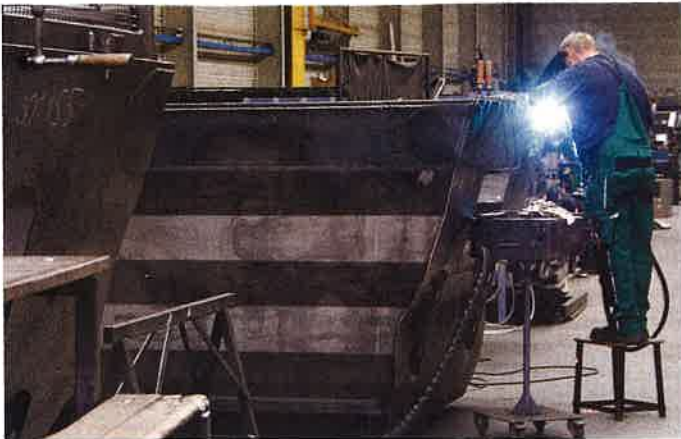
Das Schweißen der Muldenkipper-Wannen erfolgt von Hand. Viele widerkehrende Aufgaben erledigen aber Roboter.
