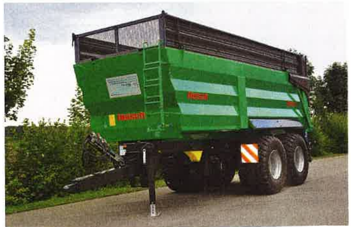
Aufgrund der Luftfederung des Fahrwerks und der Deichselfederung soll der neue Muldenkipper Agristar ein hohe Laufruhe erreichen.
