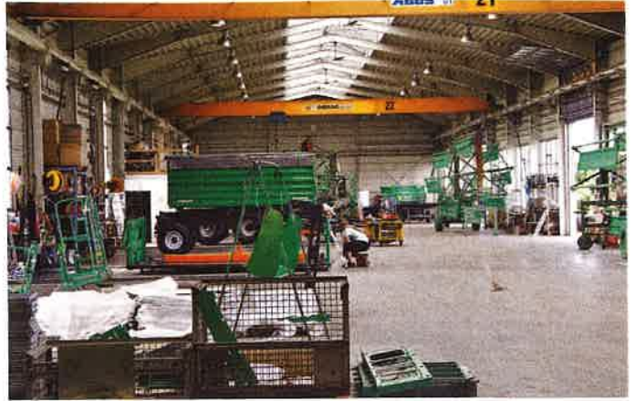
Vier Hektar Hallenfläche hat Reisch insgesamt. Hier erfolgt die Montage der Fahrgestelle mit den Brücken und Bordwänden.
